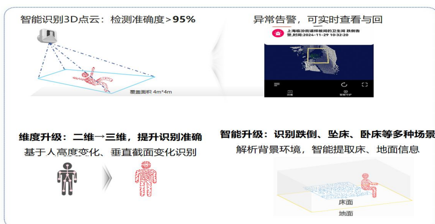
图 3-2 3D 光感跌倒监测原理
