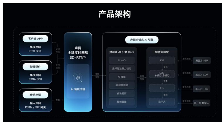
图 3-32 对话式 AI 产品架构
