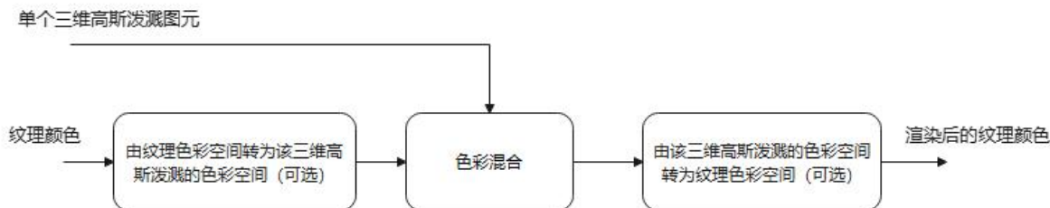
图 B.1 三维高斯泼溅的混合色彩空间渲染流程
