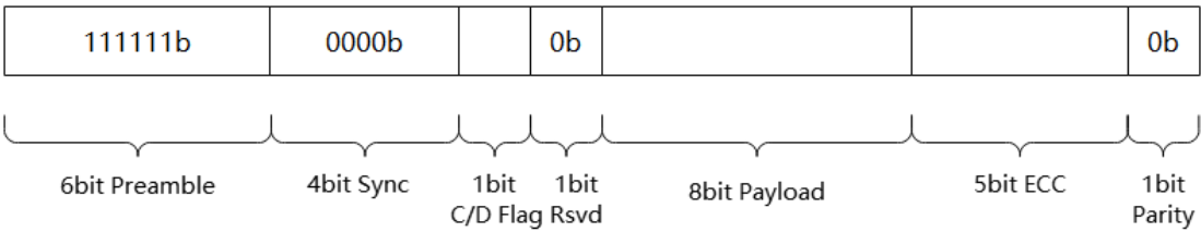
图 4 HDMI eARC 报文结构
