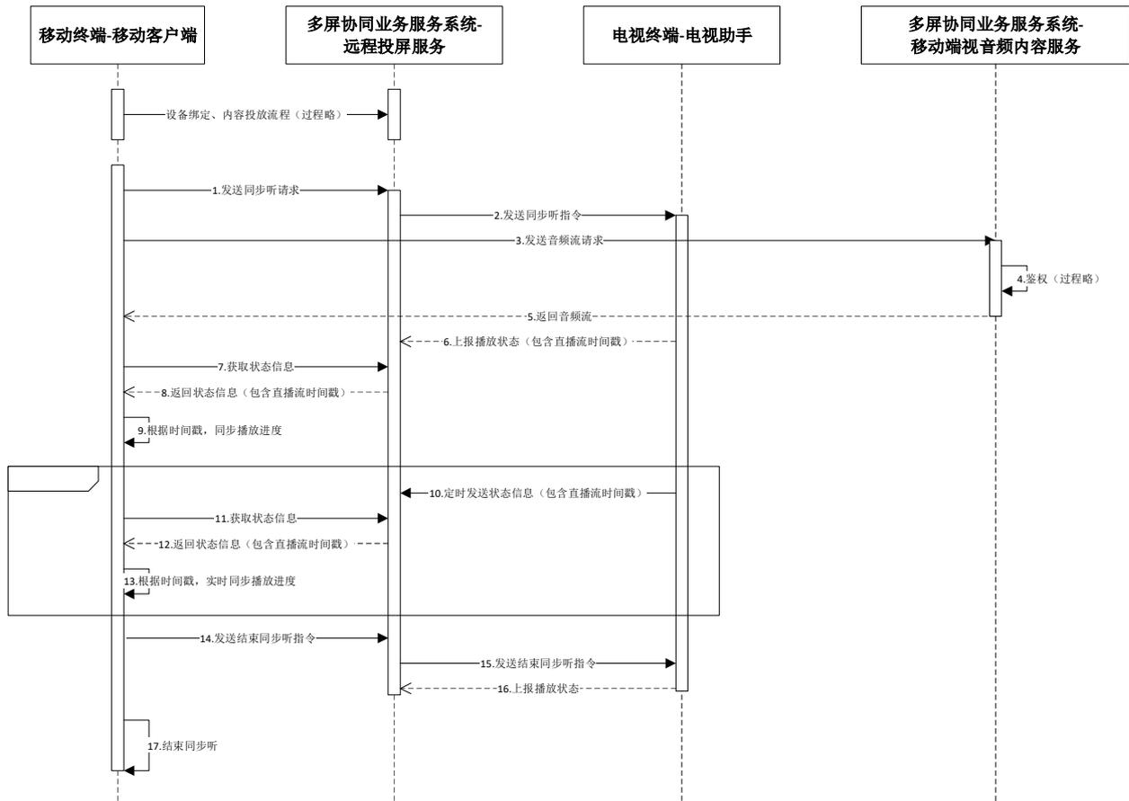
图 9 远程投屏手机同步听流程
