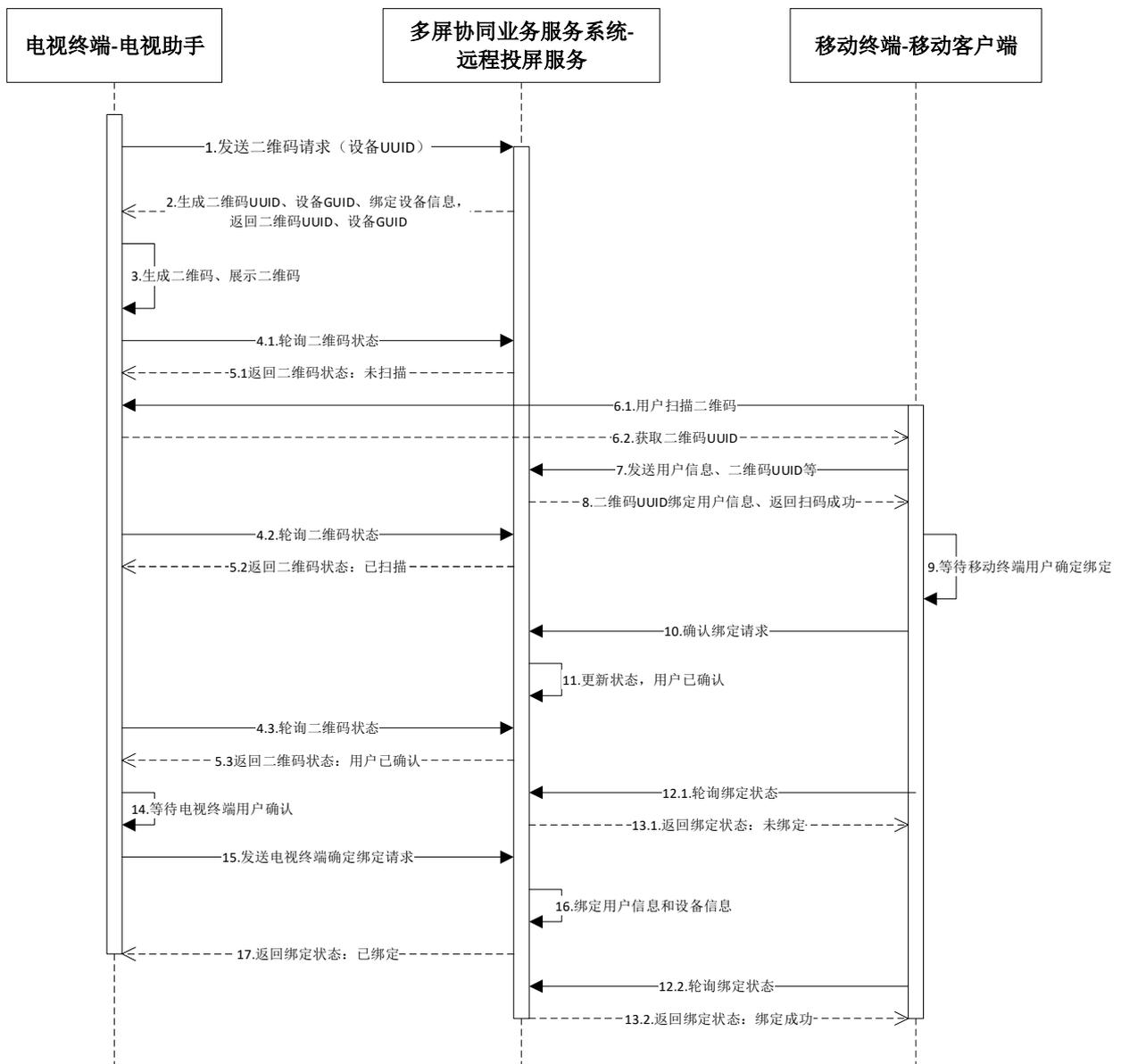
图 5 基于远程投屏的设备绑定流程
