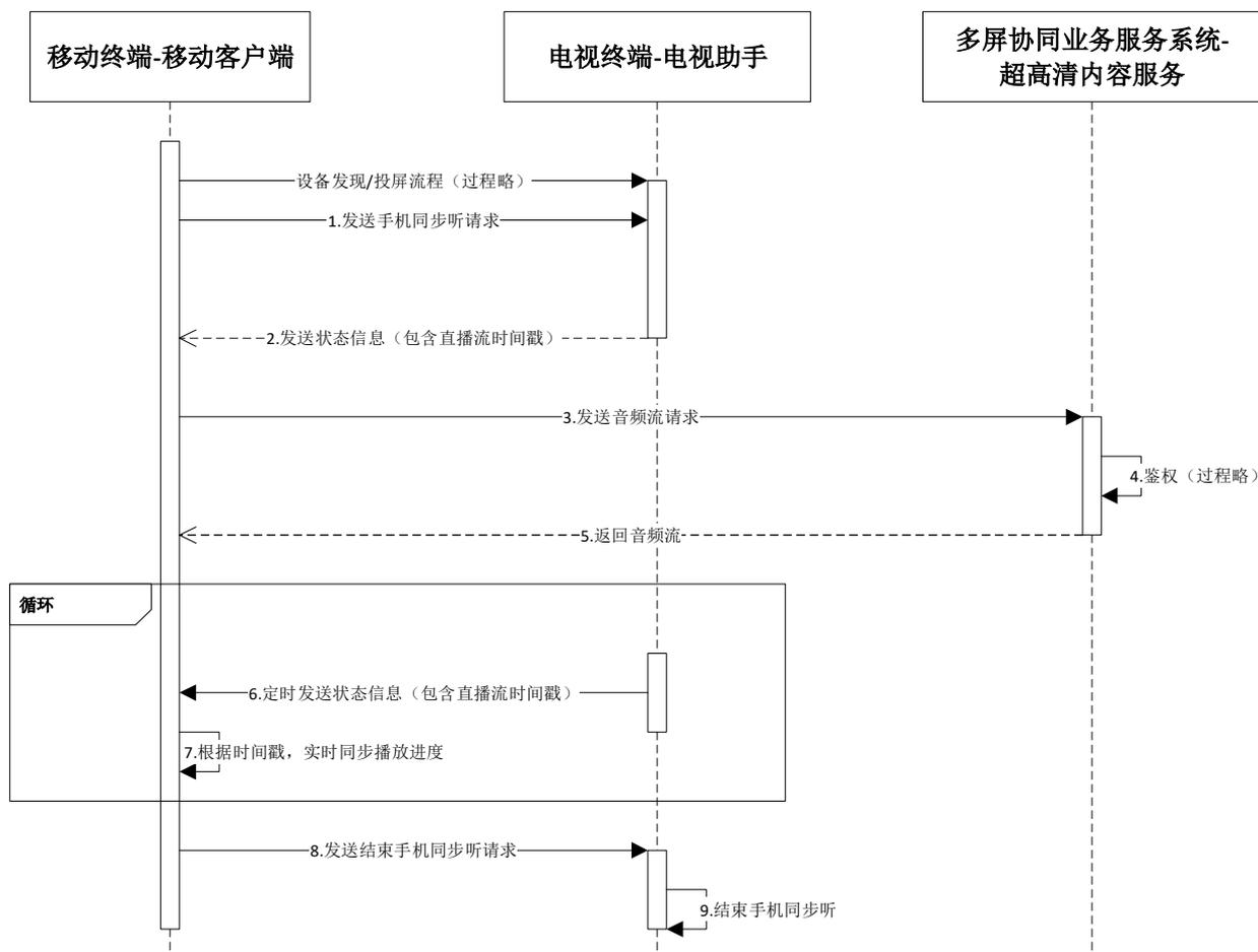
图 8 基于 DLNA 的手机同步听流程
