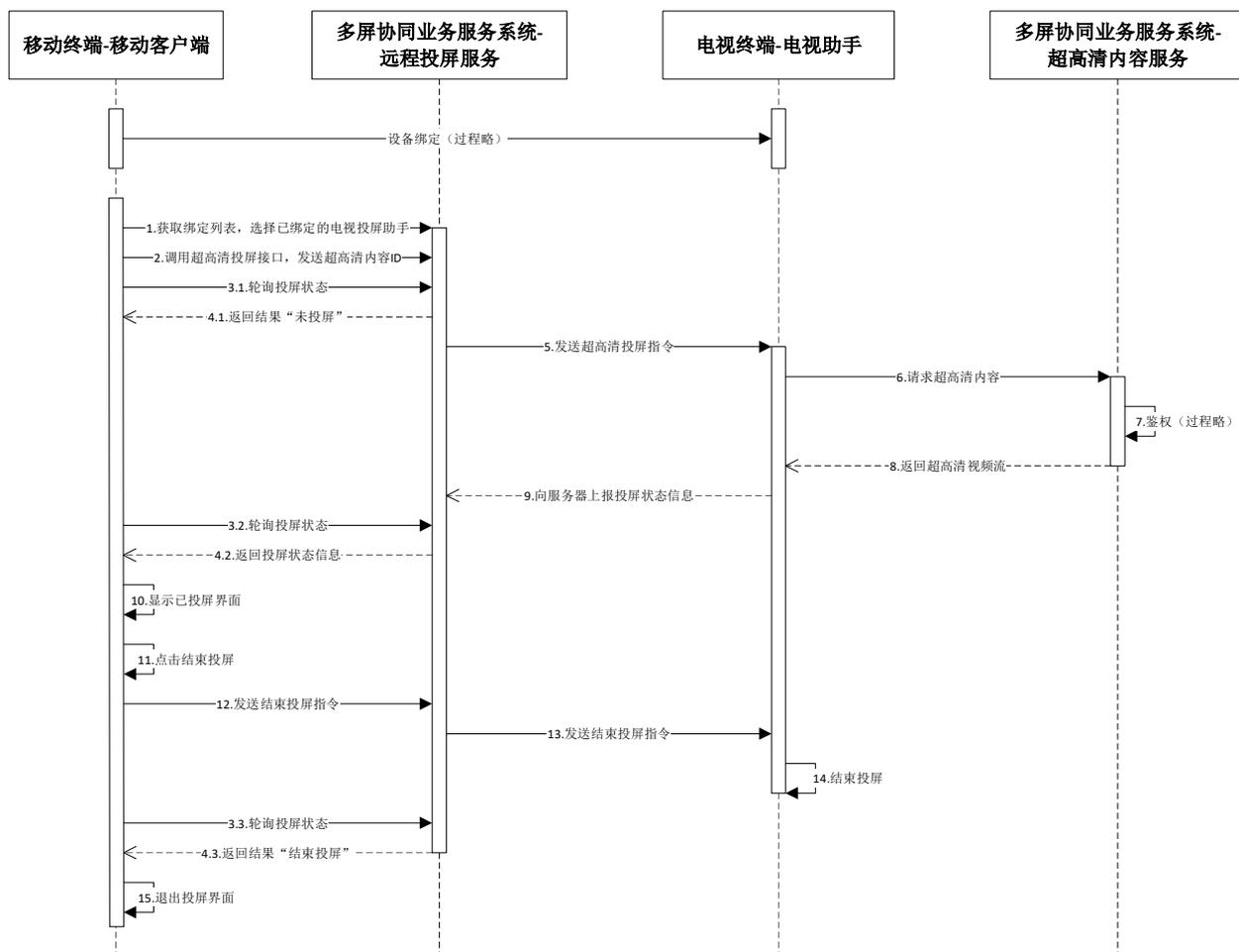
图 6 基于远程投屏的内容投放流程
