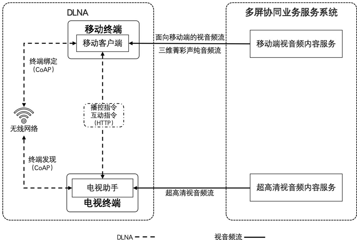
图 3 基于 DLNA 的多屏协同业务流程
