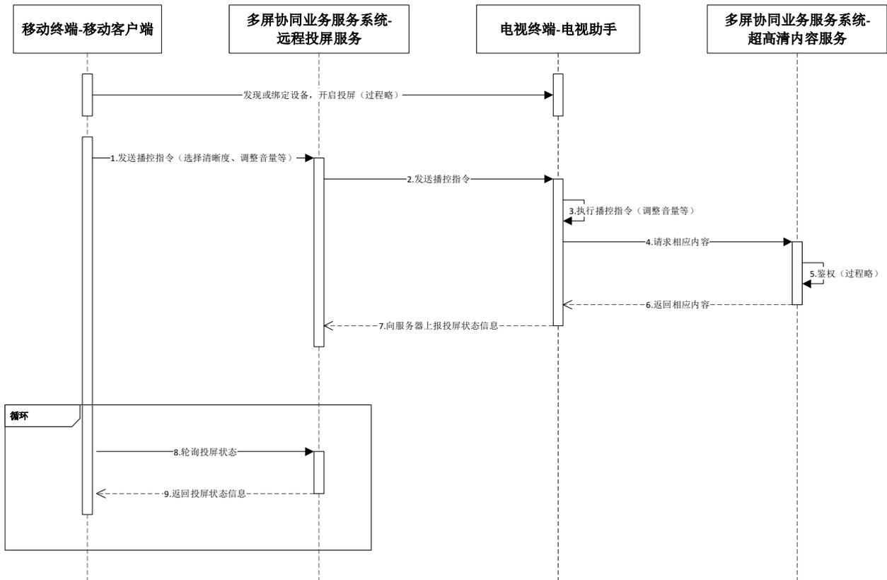
图 7 基于远程投屏的媒体播控流程
