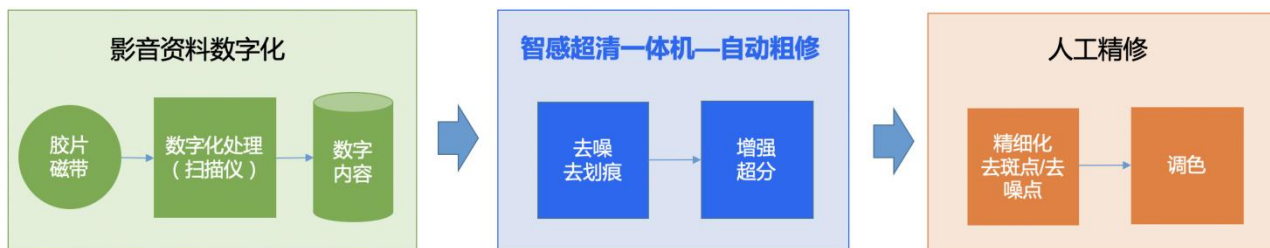
图 23 电影频道老片修复流程
