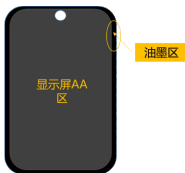
图1 显示屏显示区（AA区）和油墨区示意图
